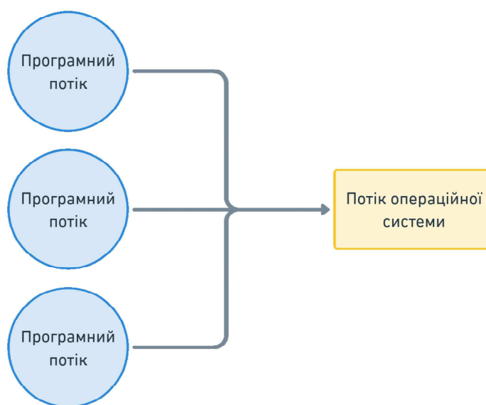
Рисунок 3.2 – Планування потоків один до багатьох
