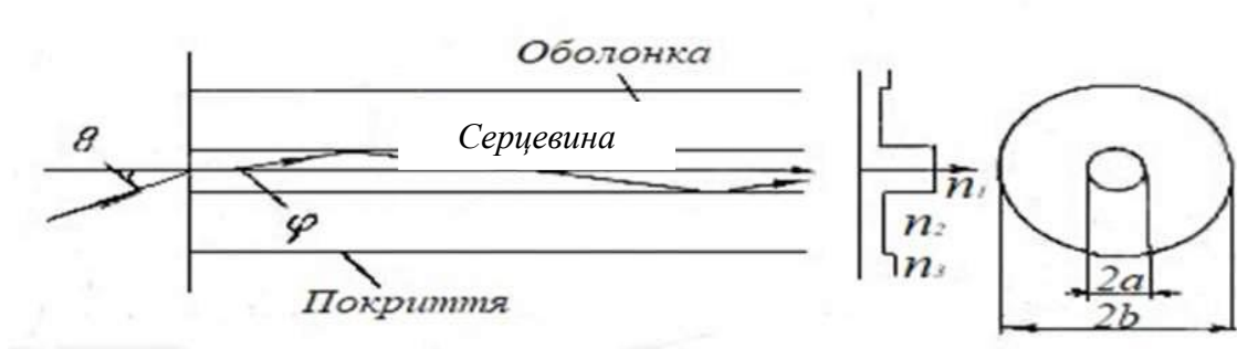
Рисунок 2.1 - Типова структура оптичного волокна та розподілу світла в ньому
