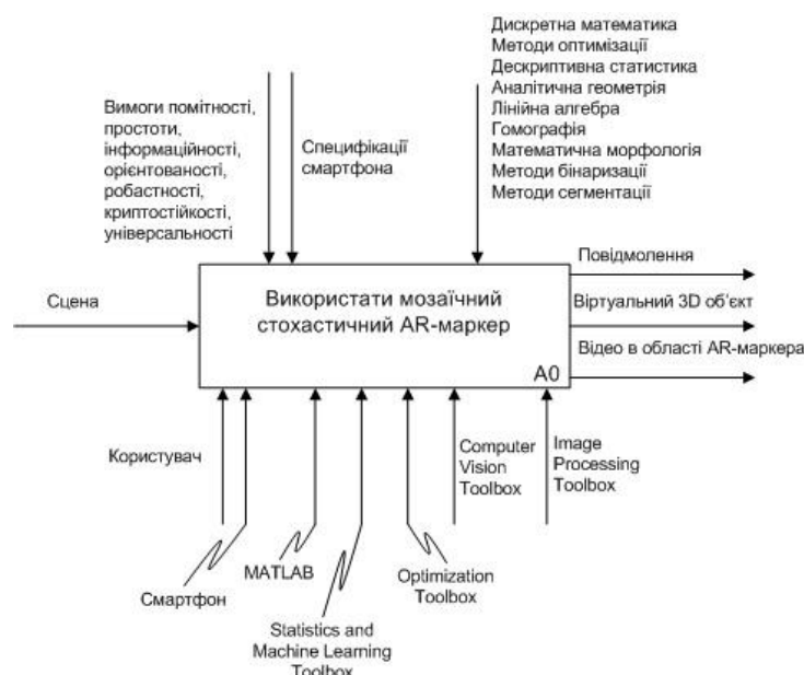
Рис. 7. Основний процес використання мозаїчного стохастичного маркера доповненої реальності
