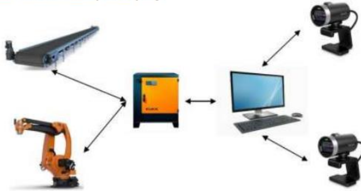
Рисунок 1 – Функціональна схема системи управління сортувальним роботом
