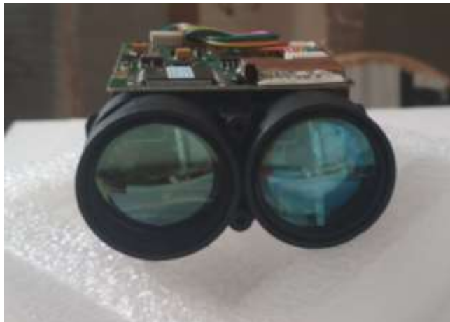
Рисунок 4.10 – Імпульсний лазер з оптичною та електронною системою
