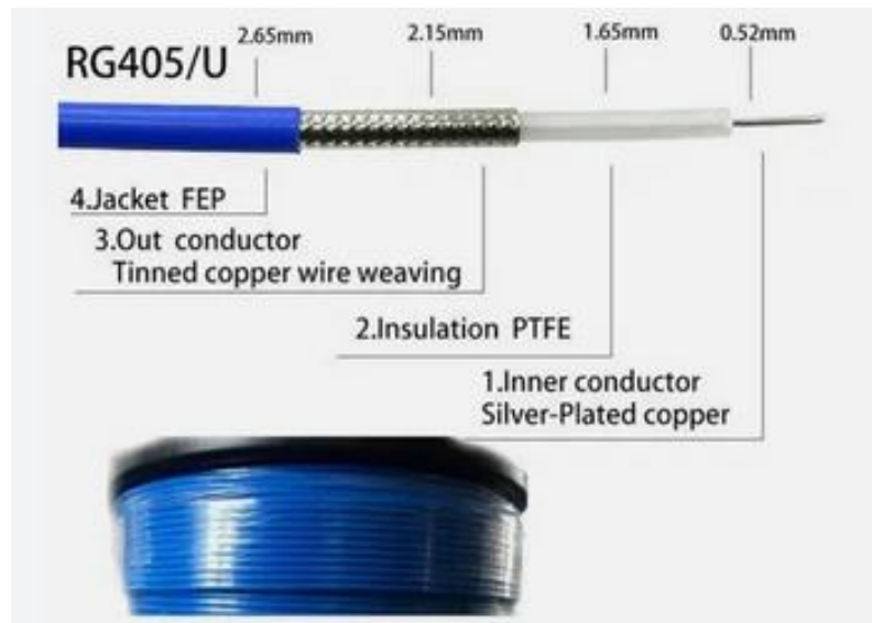
Рисунок 3.4 – Структура кабелю RG-405/U
