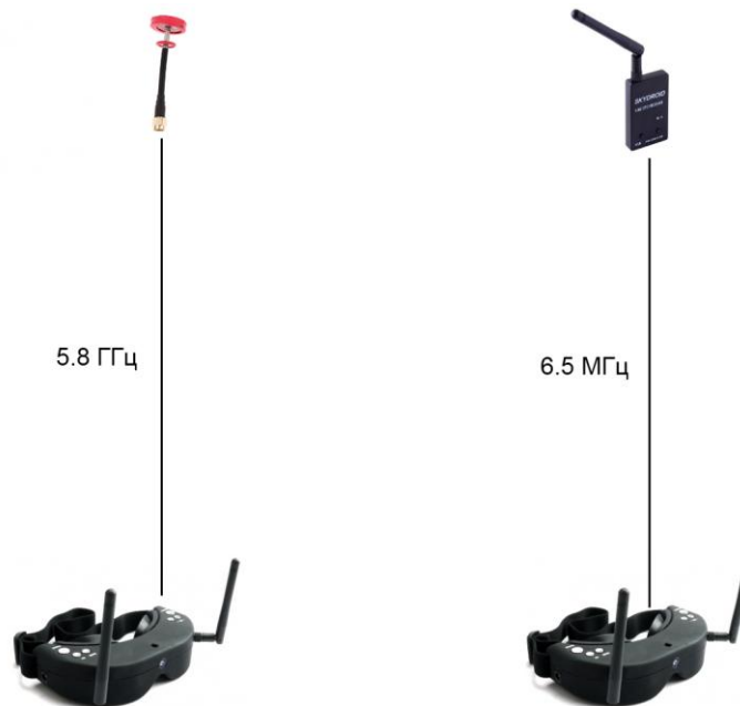
Рисунок 3.7 – Використання виносного приймача
