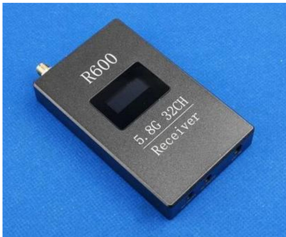
Рисунок 4.1 – Відеоприймач відеосигналу 5.8 ГГц Skyzone R600
