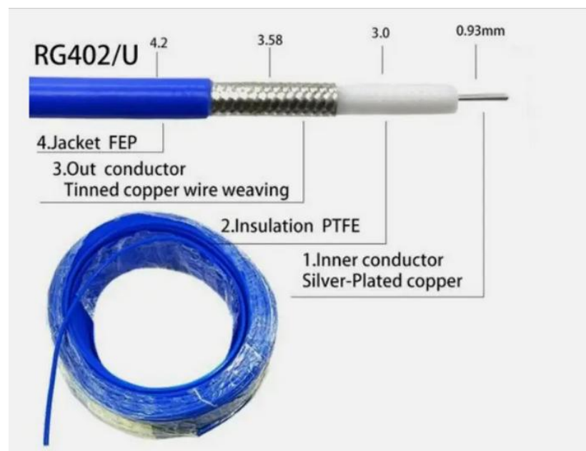
Рисунок 3.3 – Структура кабелю RG-402/U
