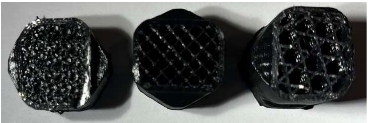
Рисунок 3.4 – Приклад надрукованих тестових зразків
