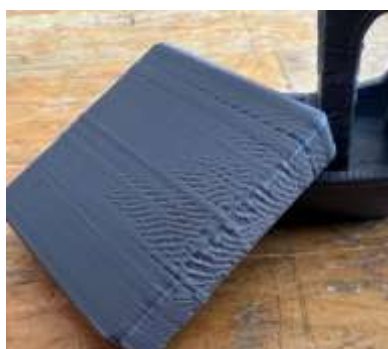
Рисунок 1.13 – Дефект друку «under-extrusion»
