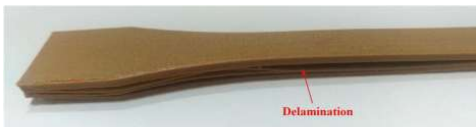
Рисунок 1.12 – Дефект друку «delamination»
