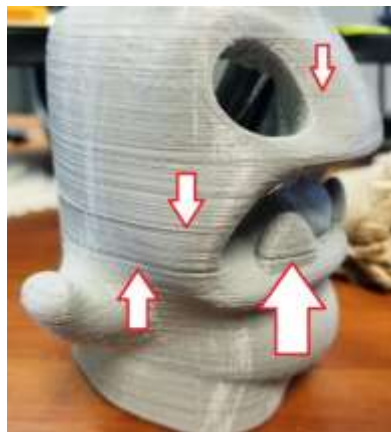
Рисунок 1.15 – Дефект друку «layer shifting»
