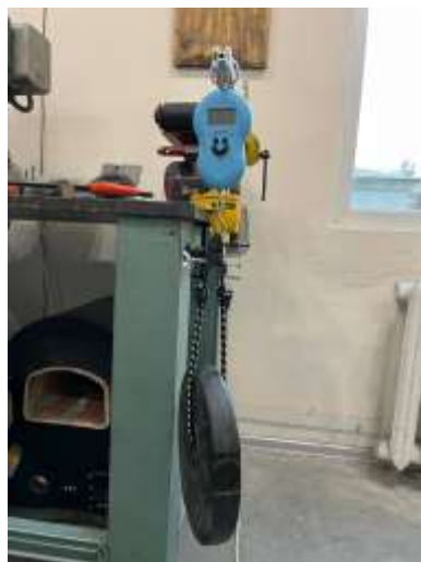
Рисунок 3.5 – Проведення досліджень на розрив зразка
