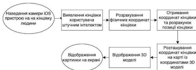
Рисунок 2 – Базовий алгоритм накладання 3D моделі на об'єкт
