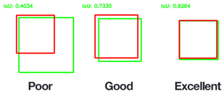
Рисунок 2.13 – Приклад обчислення IoU для різних обмежувальних рамок
