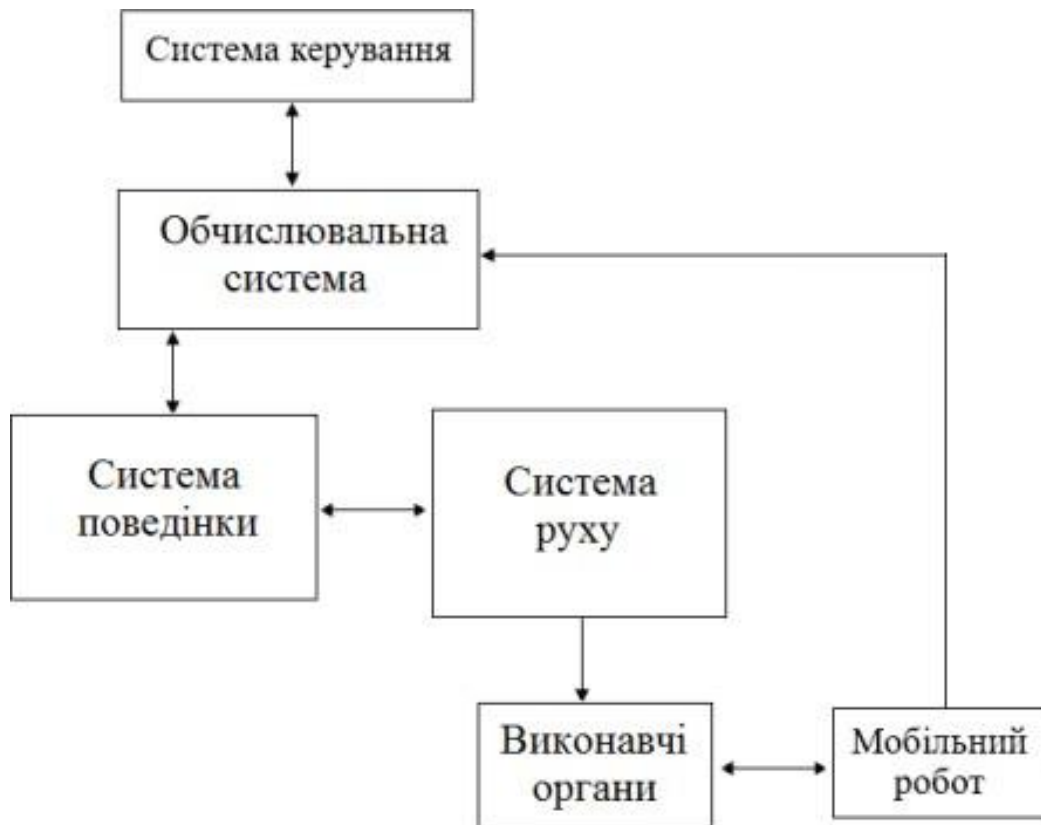
Рисунок 2.1 – Структурна схема системи керування маніпуляційним мобільним роботом
