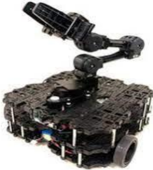
Рисунок 1.4 – Маніпуляційний мобільний робот TurtleBot 3 Burger
