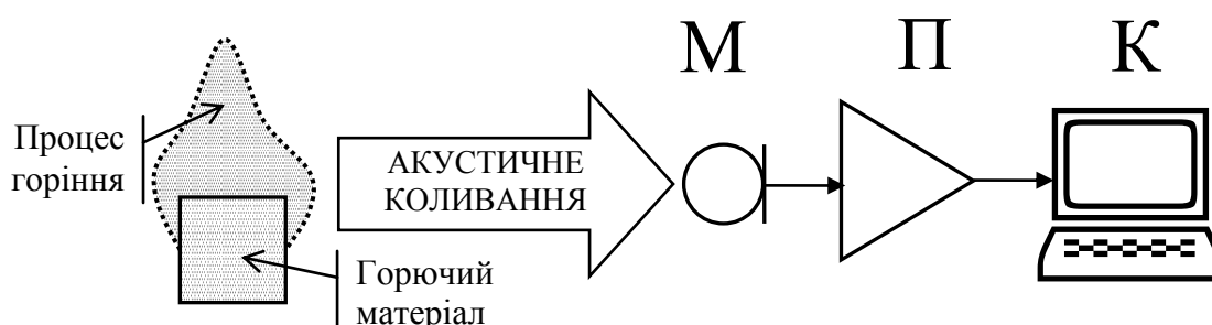
Рисунок 3.7 – Схема лабораторної установки для дослідження умов прояву ефекту акустичної емісії на стадіях горіння різних горючих матеріалів: М – мікрофон; П – підсилювач; К – комп'ютер
