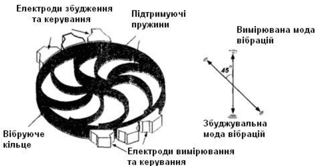
Рисунок 9.3 - Структура гіроскопа з вібруючим кільцем
