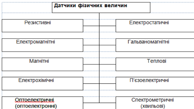
Рисунок 5.3 - Класифікація датчиків за принципом дії
