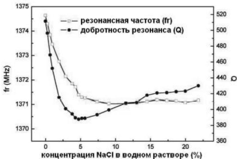
Рисунок 2.17 - Зміна f_r та Q залежно від концентрації NaCl у деіонізованій воді
