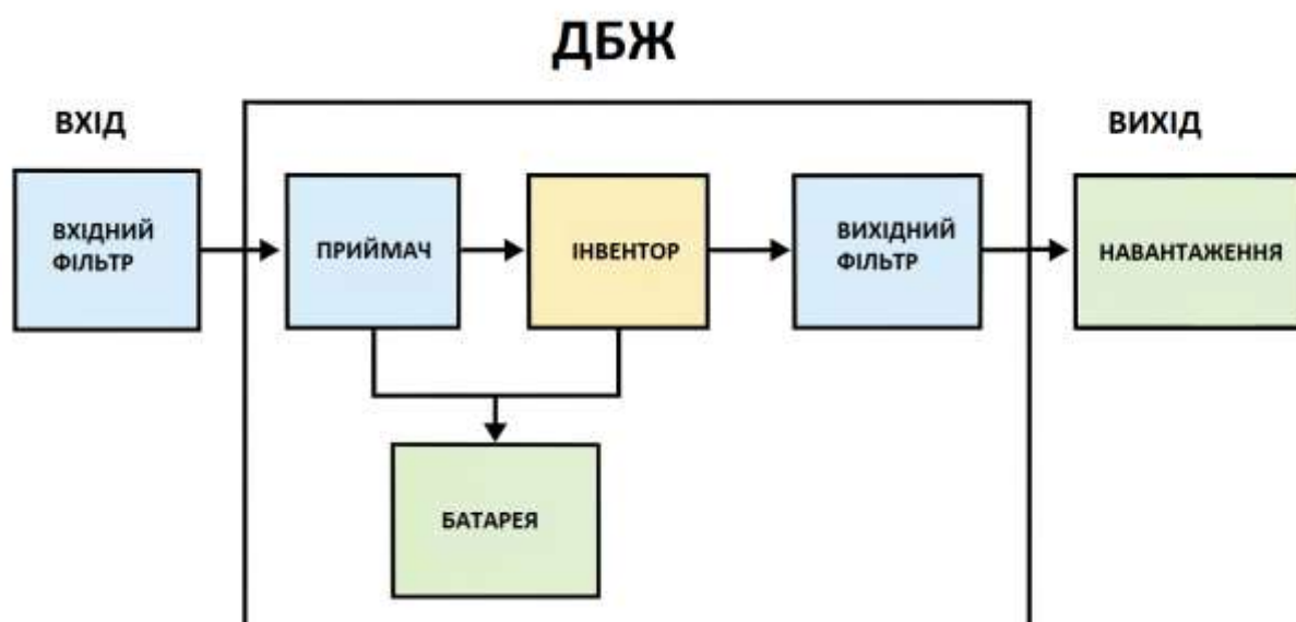
Рисунок 1.5 – Загальна схема системи ДБЖ
