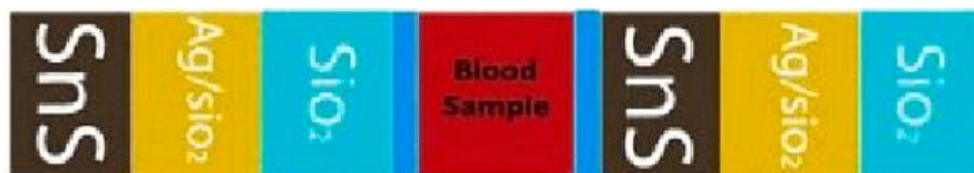
Рисунок 1.3 – Схема розташування шарів сенсорної структури для аналізу крові
