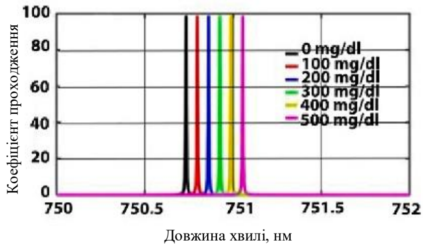
Рисунок 1.12 – Залежність коефіцієнту проходження сенсора від довжини хвилі для різних значень концентрації цукру
