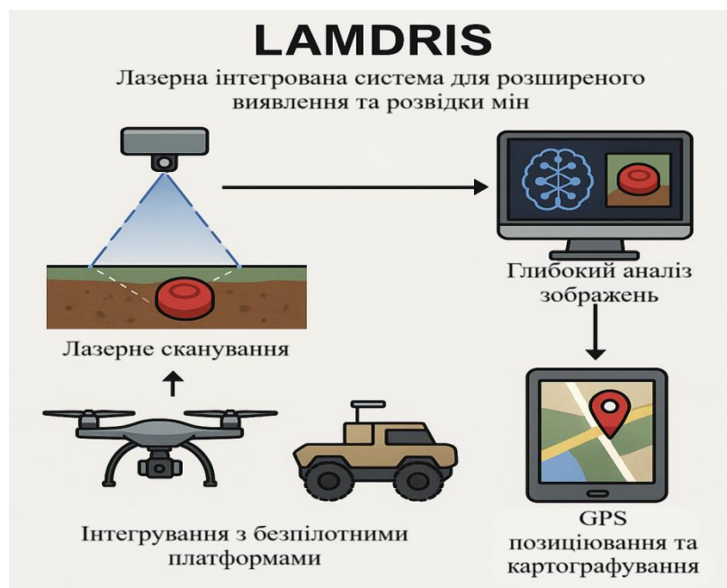
Рисунок 1.3 – Візуалізація загального принципу роботи системи LAMDRIS у контексті лазерного дистанційного зондування та просторового аналізу для виявлення мін і небезпечних об'єктів
