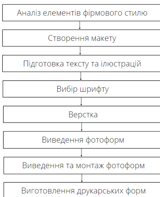
Рисунок 4.1 – Технологічна схема додрукарських процесів для офсетного друку
