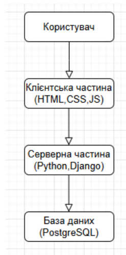
Рисунок 2.1 – Архітектура веб-застосунку для онлайн-тестування
