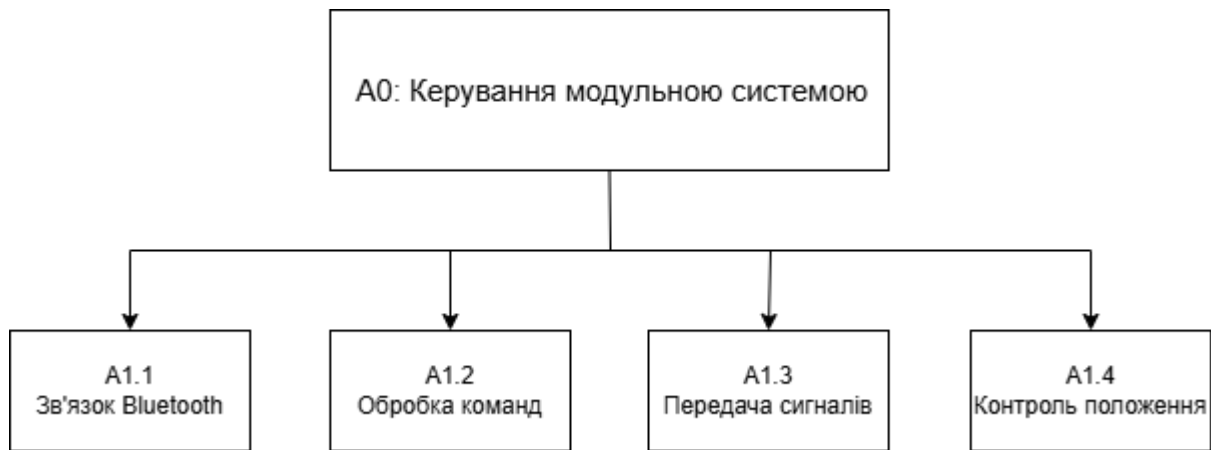
Рисунок 3.3 – Декомпозиція функцій робототехнічної системи
