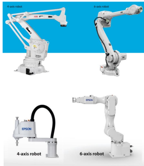
Рисунок 1.3 – Приклади промислових роботів з різною кількістю ступенів свободи
