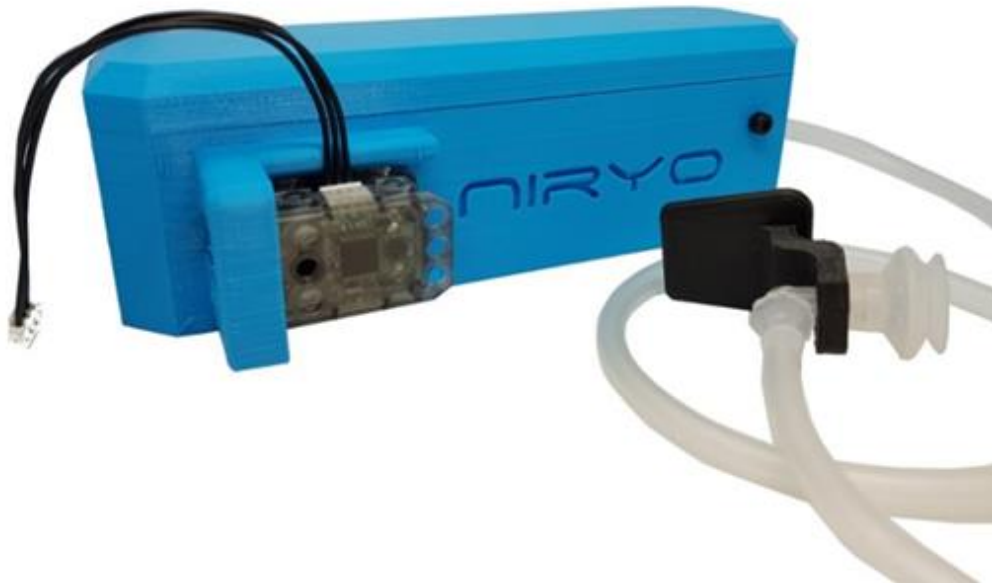
Рисунок 1.5 – Вакуумний хватний пристрій з насосом [10]
