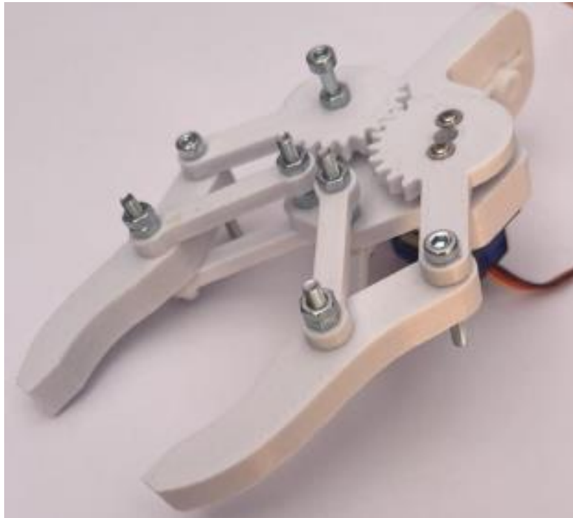
Рисунок 1.4 – Механічний захватний пристрій із зубчастою передачею [8]
