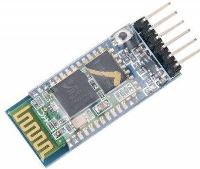
Рисунок 2.7 – HC-05 Bluetooth модуль [16]
