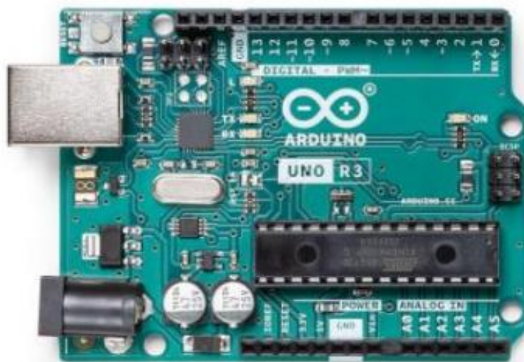
Рисунок 2.2 – Плата мікроконтролера Arduino UNO R3 [13]
