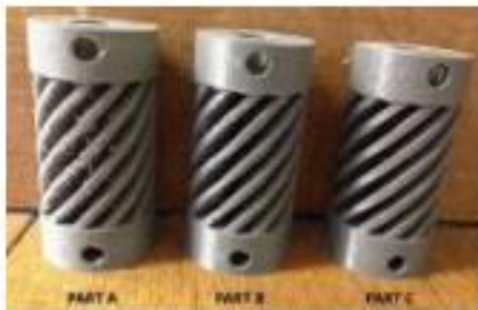
Рис.3. Порівняння надрукованих деталей з використанням екранів з різними розмірами пікселя
