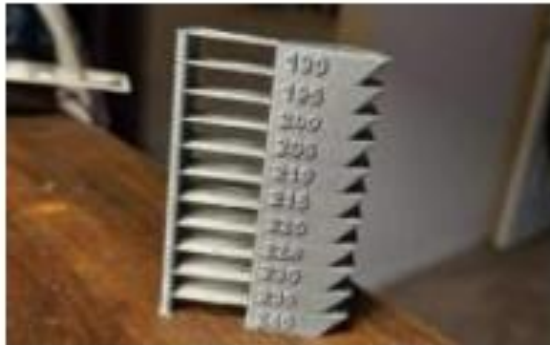
Рис.6. Порівняння екструзії при різних температурах сопла
