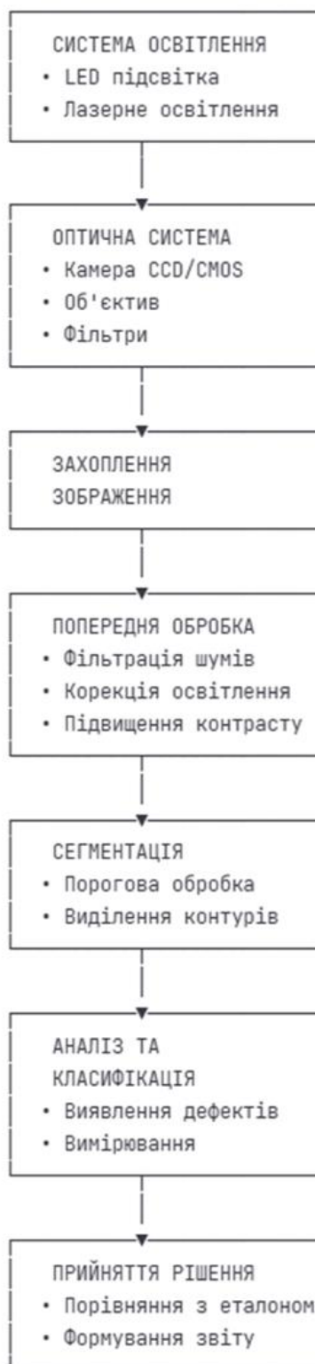
Рисунок 1.4 – Структурна схема системи технічного зору
