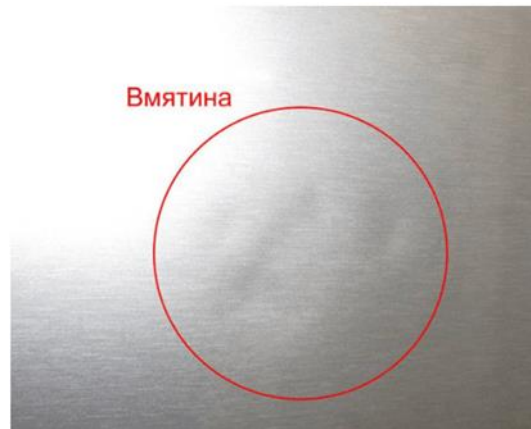
Рисунок 1.3 – Вм'ятини на полірованій металевій поверхні
