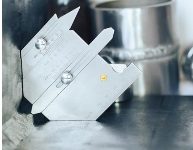
Рисунок 1.1 – Контроль якості зварного з'єднання
