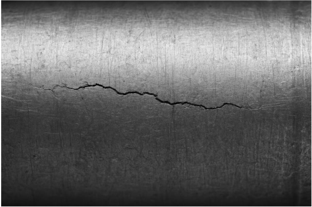
Рисунок 1.2 – Тріщина на металевій циліндричній поверхні
