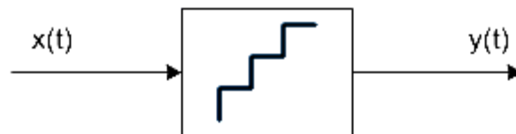
Рисунок 4.1 – Квантування сигналу шляхом усічення
