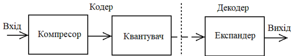
Рисунок 2.3 – Структурна схема пристрою для нерівномірного квантування звукового сигналу
