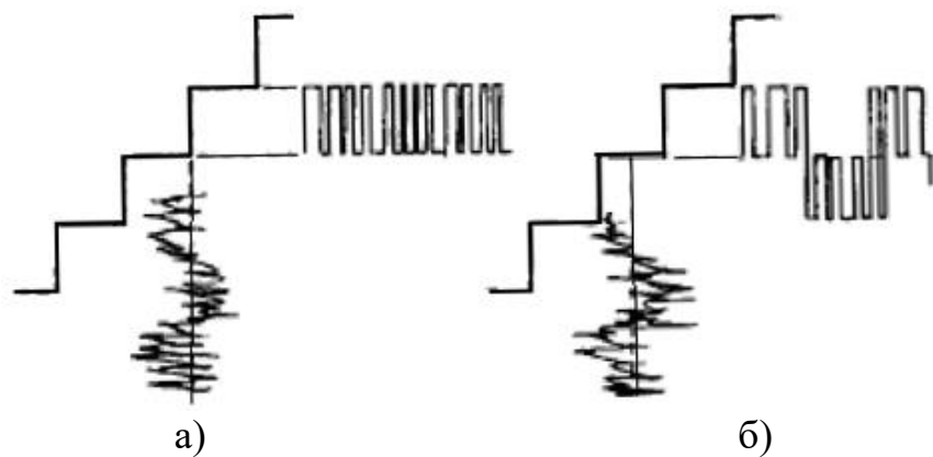
Рисунок 4.3 – Розширення динамічного діапазону АЦП за допомогою методу дитерингу (а – транкейтинг, б – округлення)
