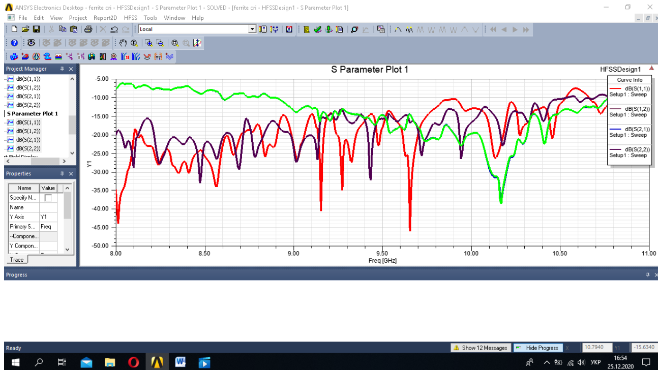
Рисунок 2.10 – Поведінка S параметрів в діапазоні частот
