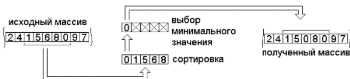
Рисунок 2.7 — Приклад реалізації «мінімального» фільтра
