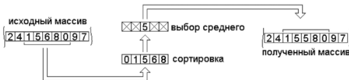
Рисунок 2.5 – Приклад роботи медіанного фільтра довжиною 5 одиниць
