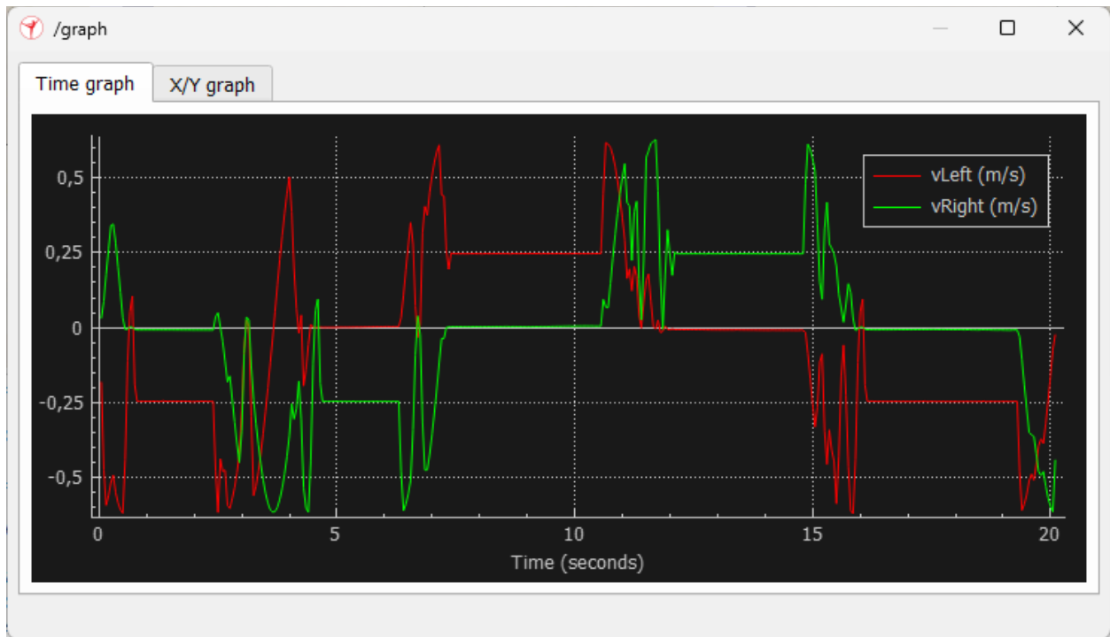
Рисунок 5.23 – Зміна швидкостей при v=30 , dv=10 , v\_sharp=25 , v\_straight=10
