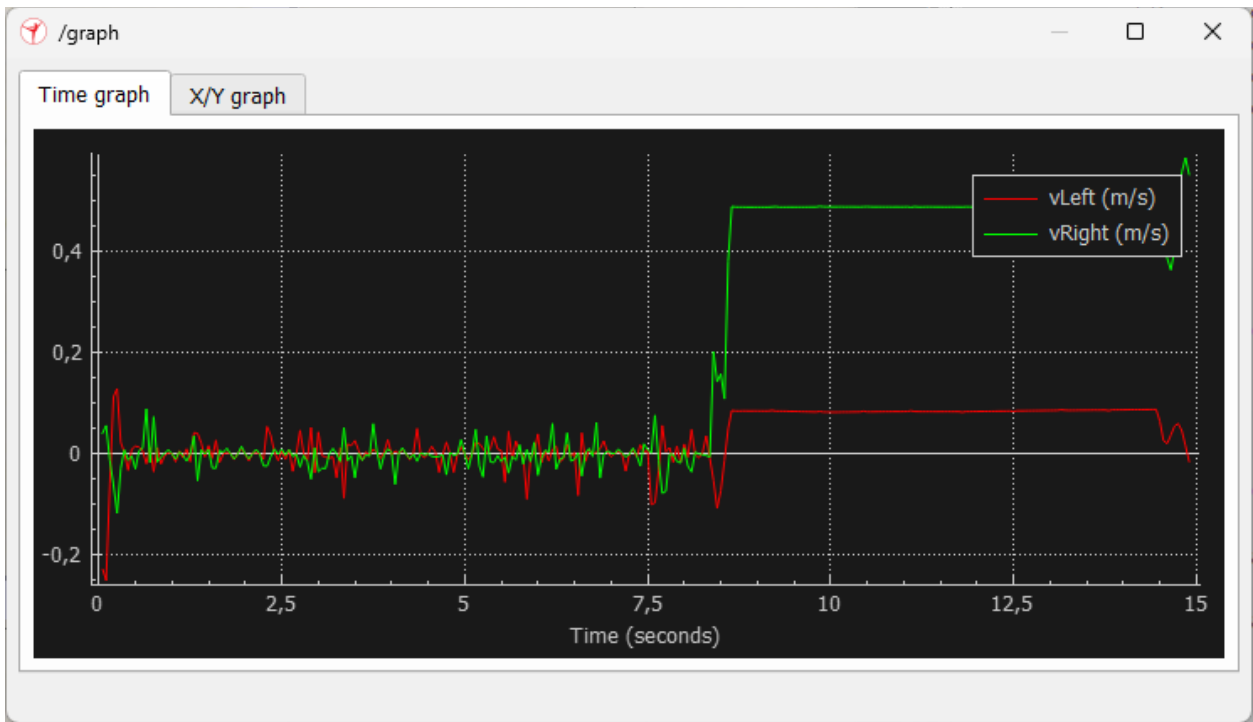
Рисунок 5.19 – Зміна швидкостей при v=10 , dv=20 , v\_sharp=20 , v\_straight=20
