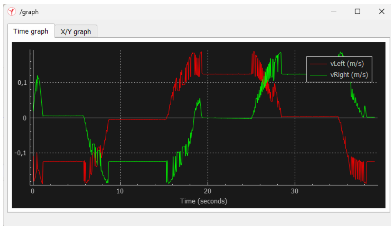
Рисунок 5.17 – Зміна швидкостей при v=10 , dv=5 , v\_sharp=10 , v\_straight=5
