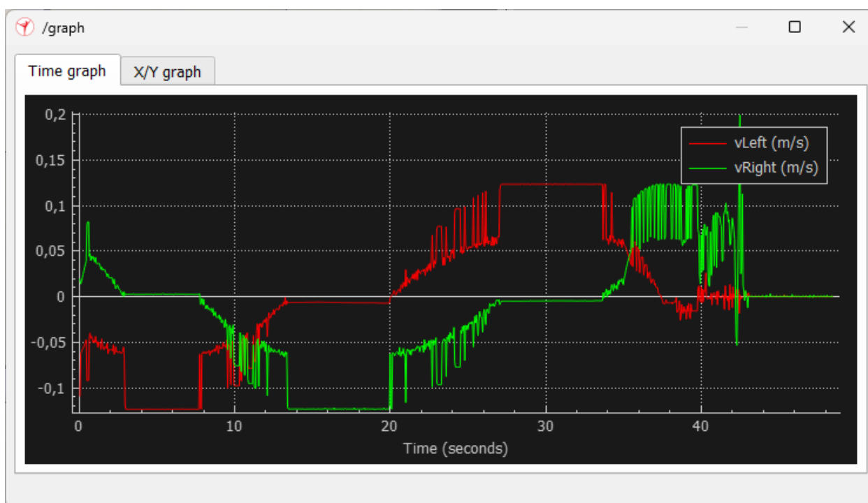
Рисунок 5.16 – Зміна швидкостей при v=5 , dv=5 , v\_sharp=5 , v\_straight=5
