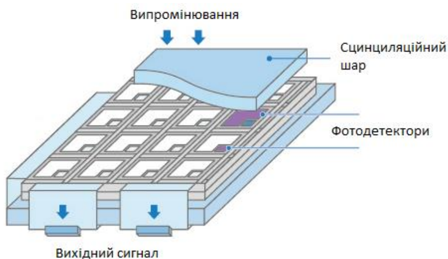
Рисунок 2.3 – Структура матриці приймача рентгенівського випромінювання
