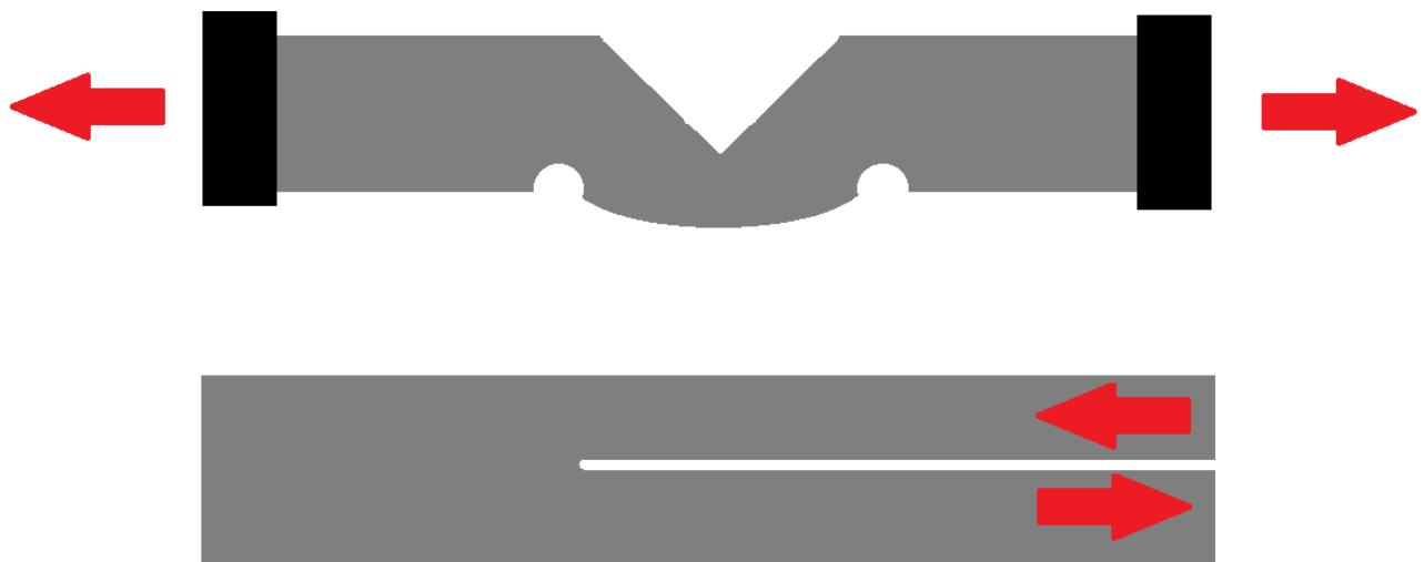
Рисунок 1.1 – Схематичне зображення тестування ГДП на розтяг і подовження
