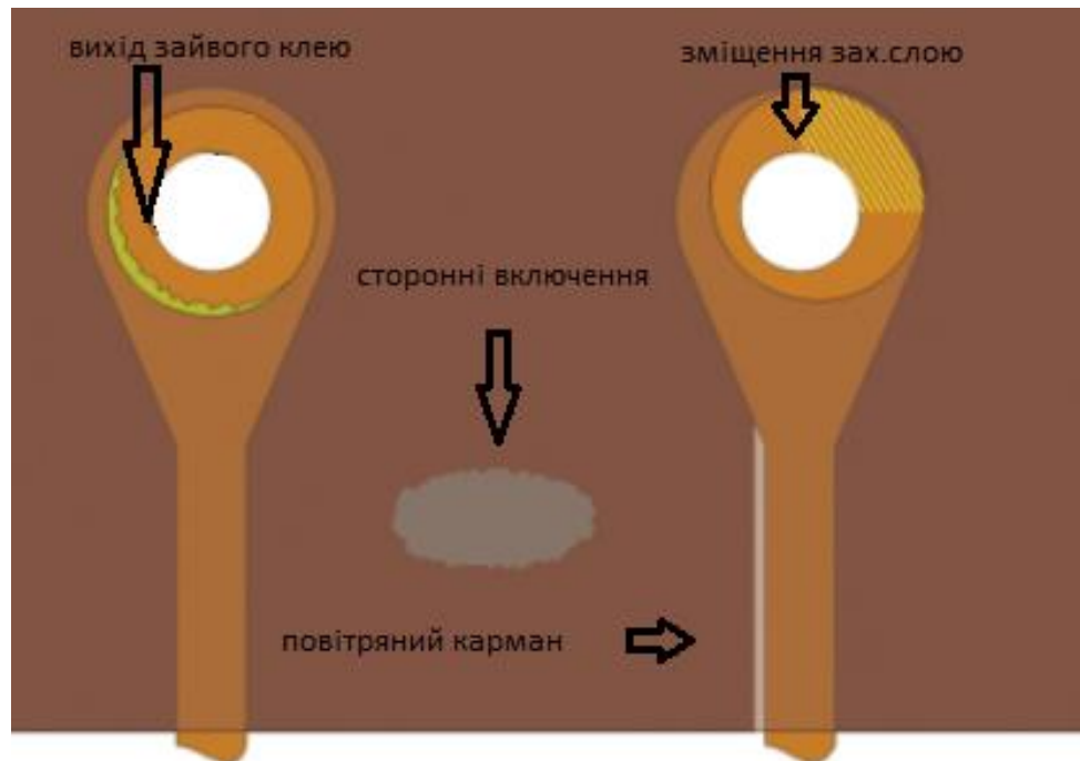
Рисунок 1.4 – Види візуальних дефектів гнучких друкованих плат
