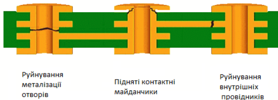
Рисунок 1.6 – Дефекти, які утворюються через температурний вплив
