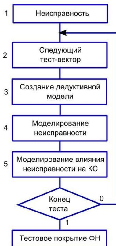
Рис. 4. Модель процесса дедуктивно-параллельного моделирования
