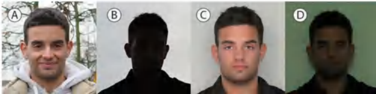
Рисунок 1 – Приклади впливу освітлення на можливість ідентифікації а) освітленості на 1600 лк та сприятливому напрямку світла; б) освітленість становить 350 лк, але є фонове засвічення; с) отримано при освітленості 7 лк та сприятливому напрямку світла; д) освітленість становить 1,5 лк
