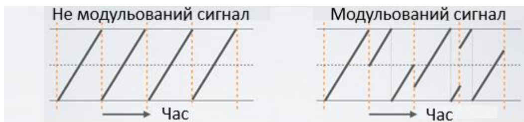
Рисунок 2.2 – Сигнал до та після модуляції LoRa [12]
