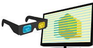
Рисунок 75 – Пристрій з пасивним поляризованим екраном
