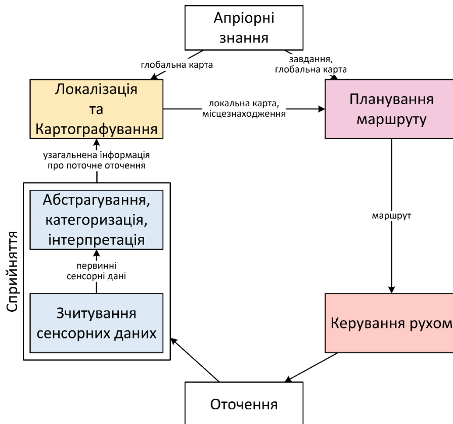
Рисунок 1.2 – Процес управління переміщенням АО (адаптовано з [11])
