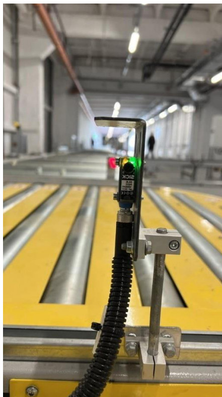
Рисунок 3.6 – Правильна настройка оптического сенсора
