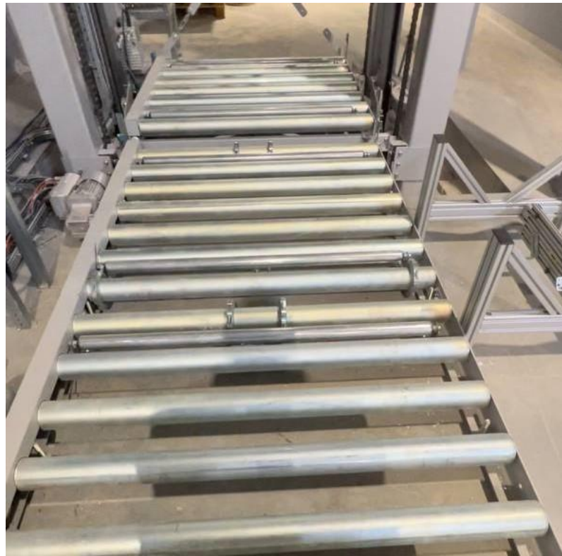
Рисунок 3.1 – Палетний конвеєр з механічним трігером
