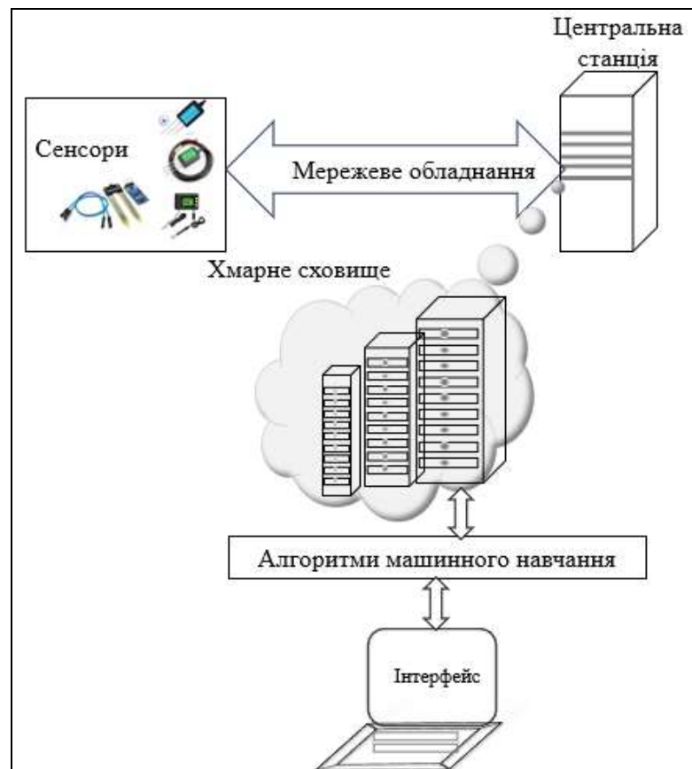
Рисунок 4.1 – Структурна схема запропонованої інтелектуальної системи моніторингу ґрунту
