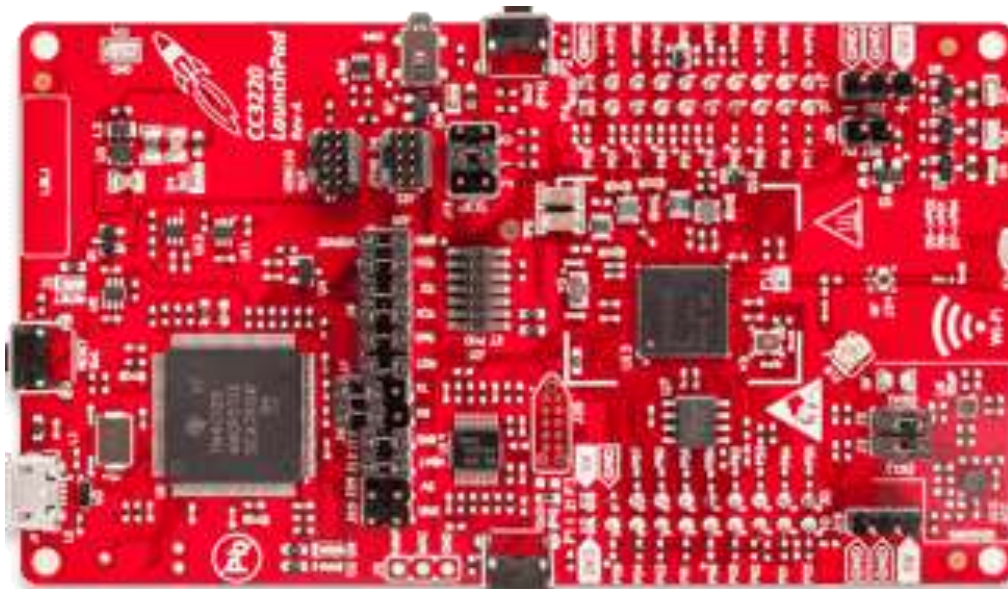
Рисунок 4.2 – Однокристальний програмований мікроконтролер CC3200 з вбудованим підключенням Wi-Fi
