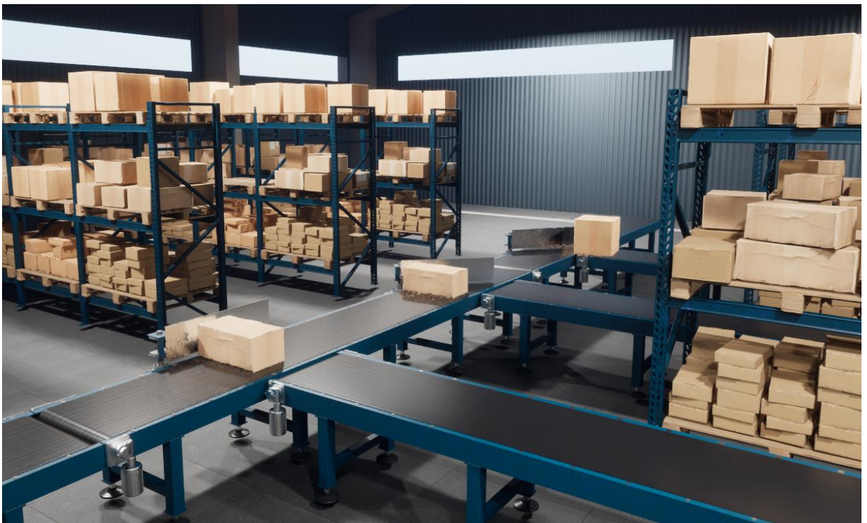
Рисунок 4.3 – Робота лопаткових сортувальників
