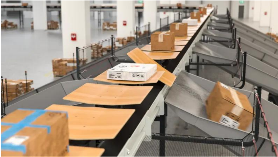
Рисунок 1.5 – Сортувальники з перекидними лотками [18]
