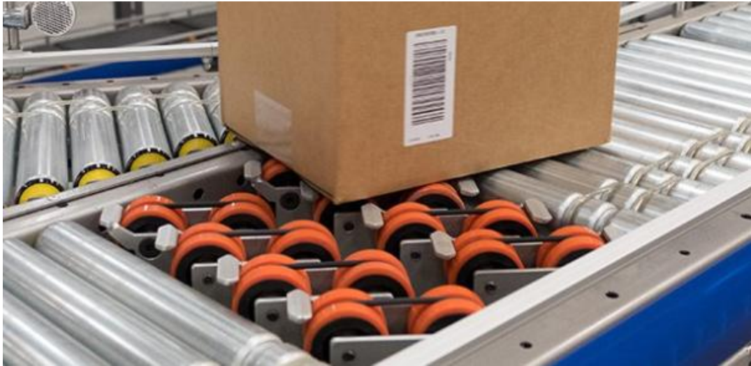
Рисунок 1.8 – Зображення сортувальники з шарнірними колесами [20]
