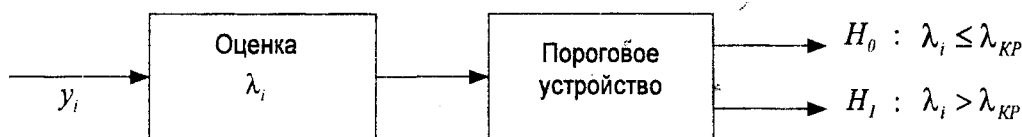
Рис. 1. Структурная схема обнаружителя критического уровня нагрузки \lambda_{KP}
