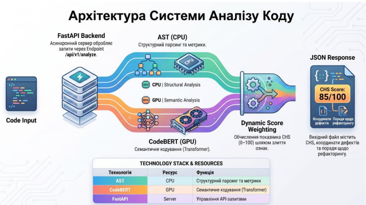
Рисунок 2.1 – Компонентна архітектура та двопотоковий конвеєр інтелектуального аналізу програмного коду
