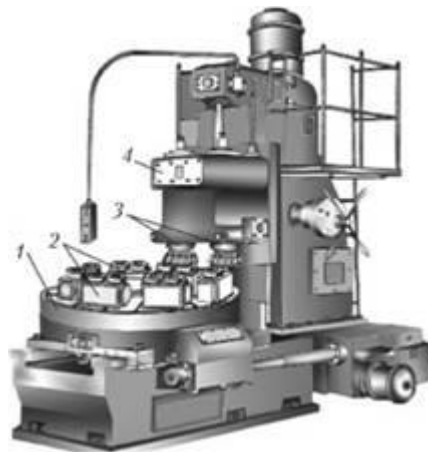
1 – стіл; 2 – заготовки; 3 – шпинделі; 4 – фрезерна головка
