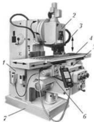
1 – вертикальна стійка; 2 головка; 3 – шпиндель; 4 стіл; 5 – каретка; 6 – консоль; 7 – станина
