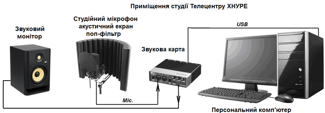
Рисунок 3.4 – Структурна схема експериментального дослідження імпульсних сигналів збудження
