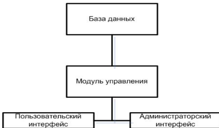
Рисунок 1 – Укрупненная структурная схема системы ДО
