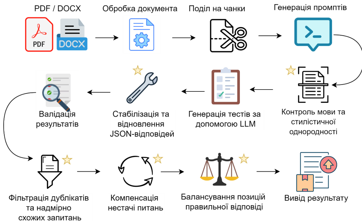
Рисунок 2.7 – Удосконалена схема процесу генерації тестових запитань з використанням LLM
