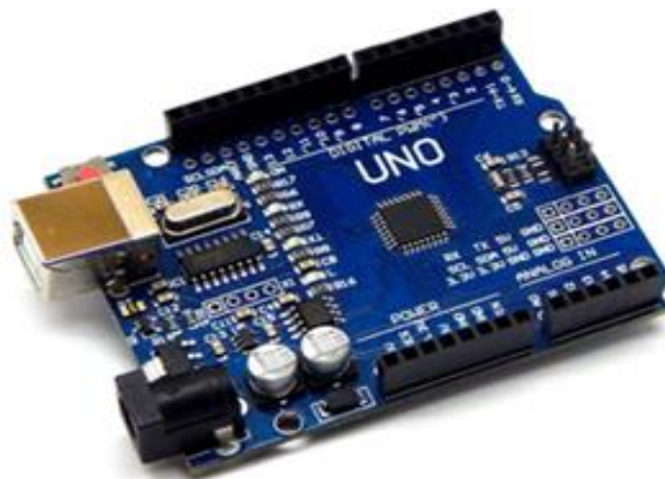
Рисунок 3.3 – Центральний мікроконтролер Arduino Uno
