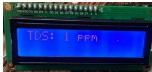
Рисунок 4.9 – Результат тестування роботи датчика TDS
