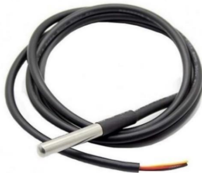
Рисунок 3.5 – Цифровий датчик температури DS18B20
