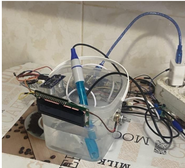
Рисунок 4.6 – Система дослідження екологічного стану водного середовища
