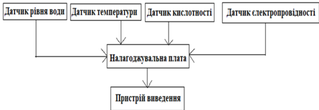
Рисунок 3.1 – Структурна схема системи дослідження водного середовища
