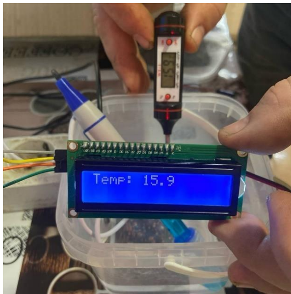
Рисунок 4.7 – Результат тестування роботи датчика температури DS18B20
