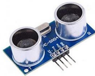
Рисунок 3.4 – Ультразвуковий датчик відстані HC-SR
