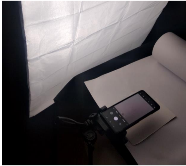
Рисунок 3.3 – Експеримент з вимірювання відношення сигнал-шум у зображеннях
