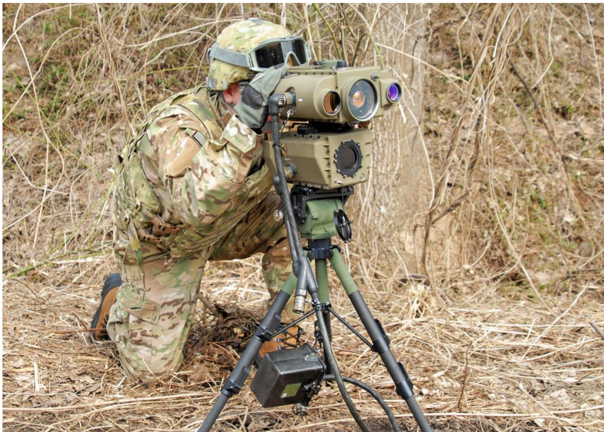
Рисунок 1.8 — Військовий лазерний імпульсний далекомір LLDR 2H
