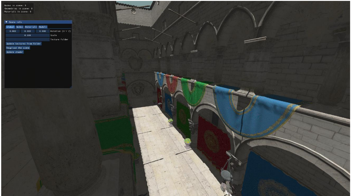
Рисунок 3.5 – Використання методу карт тіней з моделлю освітлення Бліна-Фонга
