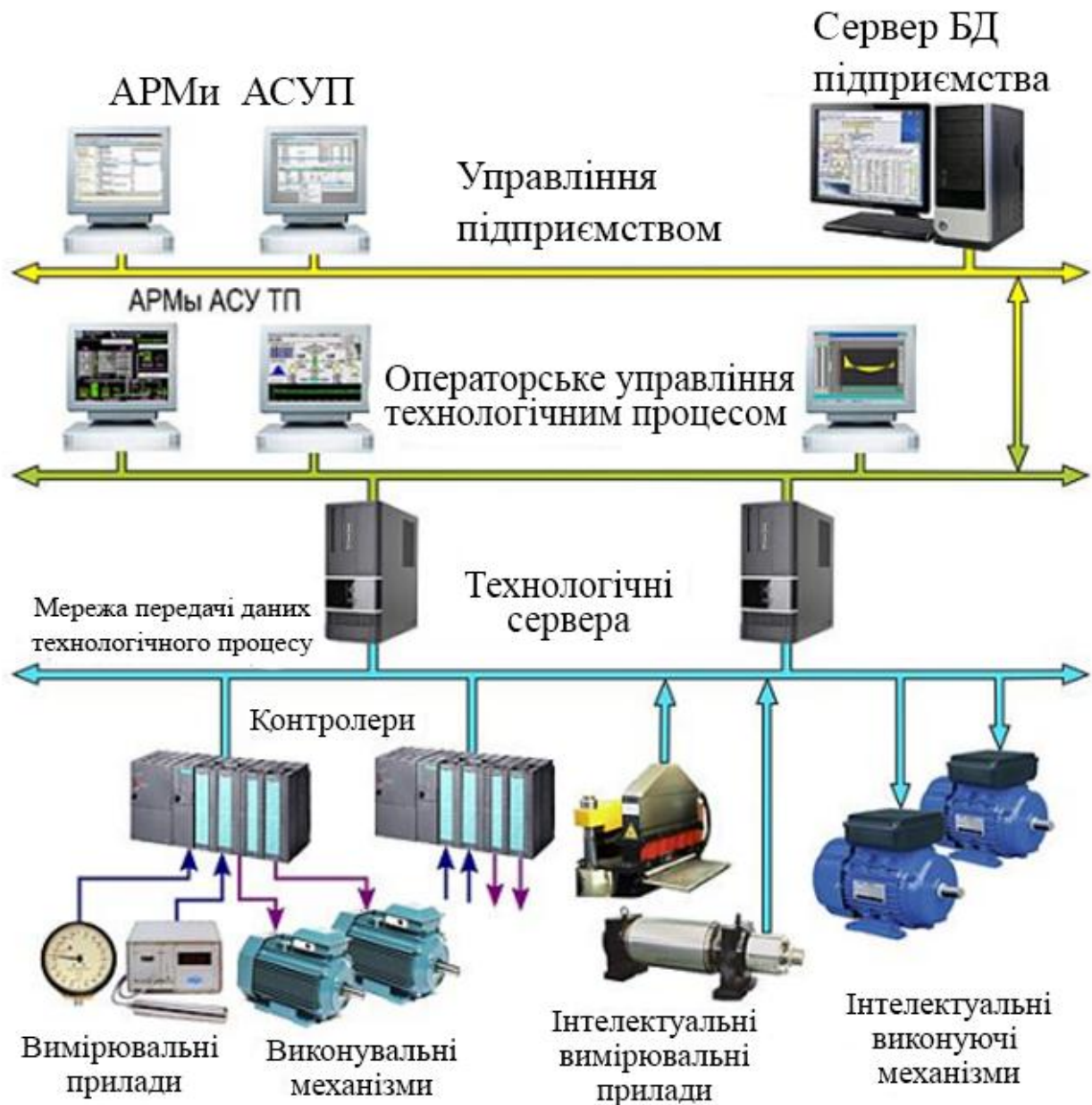
Рисунок 3.1 – Структура сучасної промислової системи автоматизованого управління виробництвом.
