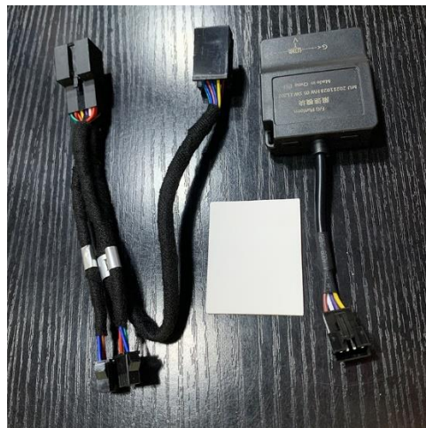
Рисунок 1.14 – Необхідні компоненти для роботи BMW - Speed Limit Info
