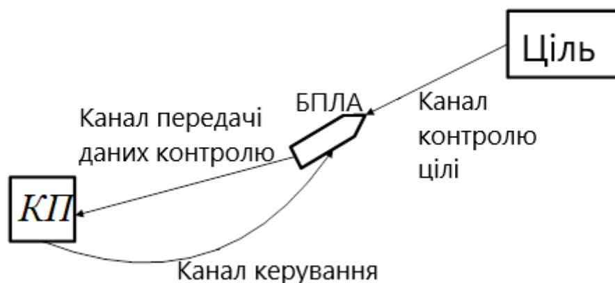
Рисунок. 1.3 - Телекерування з контролем цілі за допомогою бортової апаратури
