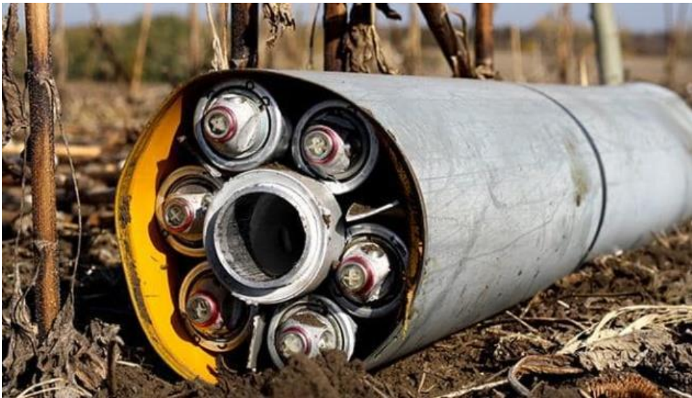
Рисунок 1.5 – Касетна бомба з відкритою серединою [13]
