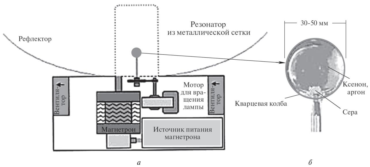
Рис. 6. Устройство безэлектродной серной лампы с СВЧ-накачкой
