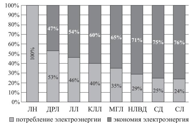
ЛН – лампы накаливания; ДРЛ – ртутные лампы; ЛЛ – люминесцентные лампы; МГЛ – металлогалогенные лампы; НЛВД – натриевые лампы высокого давления; СД – светодиодные лампы; СЛ – безэлектродные серные лампы с СВЧ накачкой
