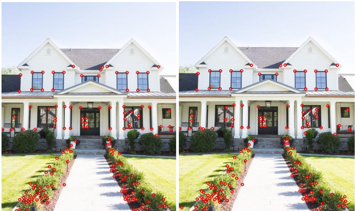
Рисунок 2.2 – Кути Гарріса та Ши-Томасі
