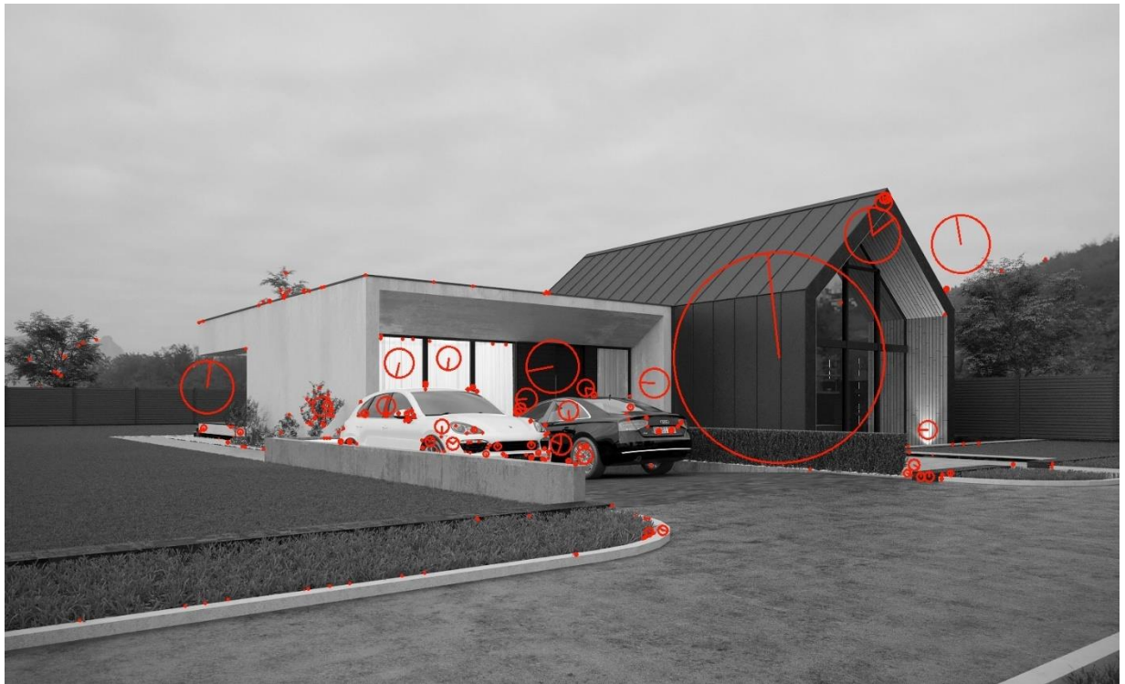
Рисунок 2.4 – Наслідок роботи детектора SIFT
