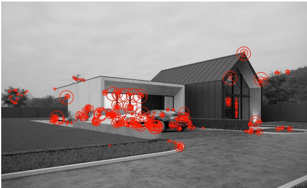
Рисунок 2.9 – Наслідок роботи алгоритму BRISK
